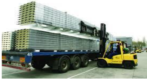
(demonstration des entladens von paneelen mit einem gabelstapler)
