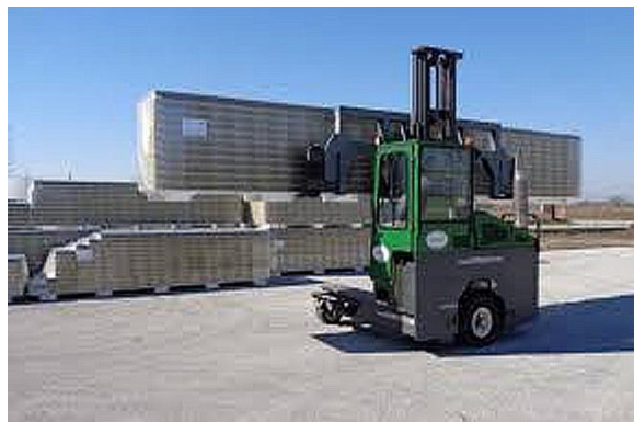
(demonstration des entladens von paneelen mit einem seitenstapler)
